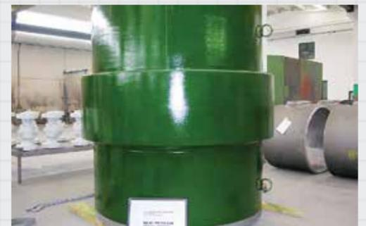
Изолирующая монолитная муфта с температурой эксплуатации до +250°C
