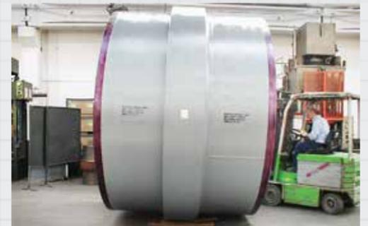
Изолирующая монолитная муфта диаметром 88 дюймов (2235 мм) на рабочее давление 9,8 МПа
