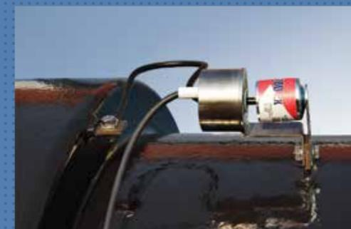
Контроллер МКИ, установленный в КИП
