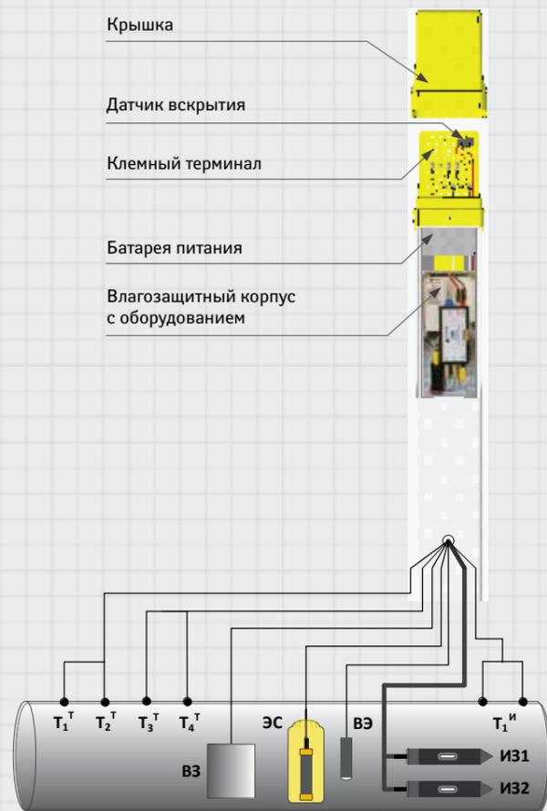
ПКМ-ТСТ-КонтКорр® – подсистема для измерения скорости коррозии и одновременно широкого спектра электрических параметров коррозионной среды, в которой находится данный участок трубопровода.
